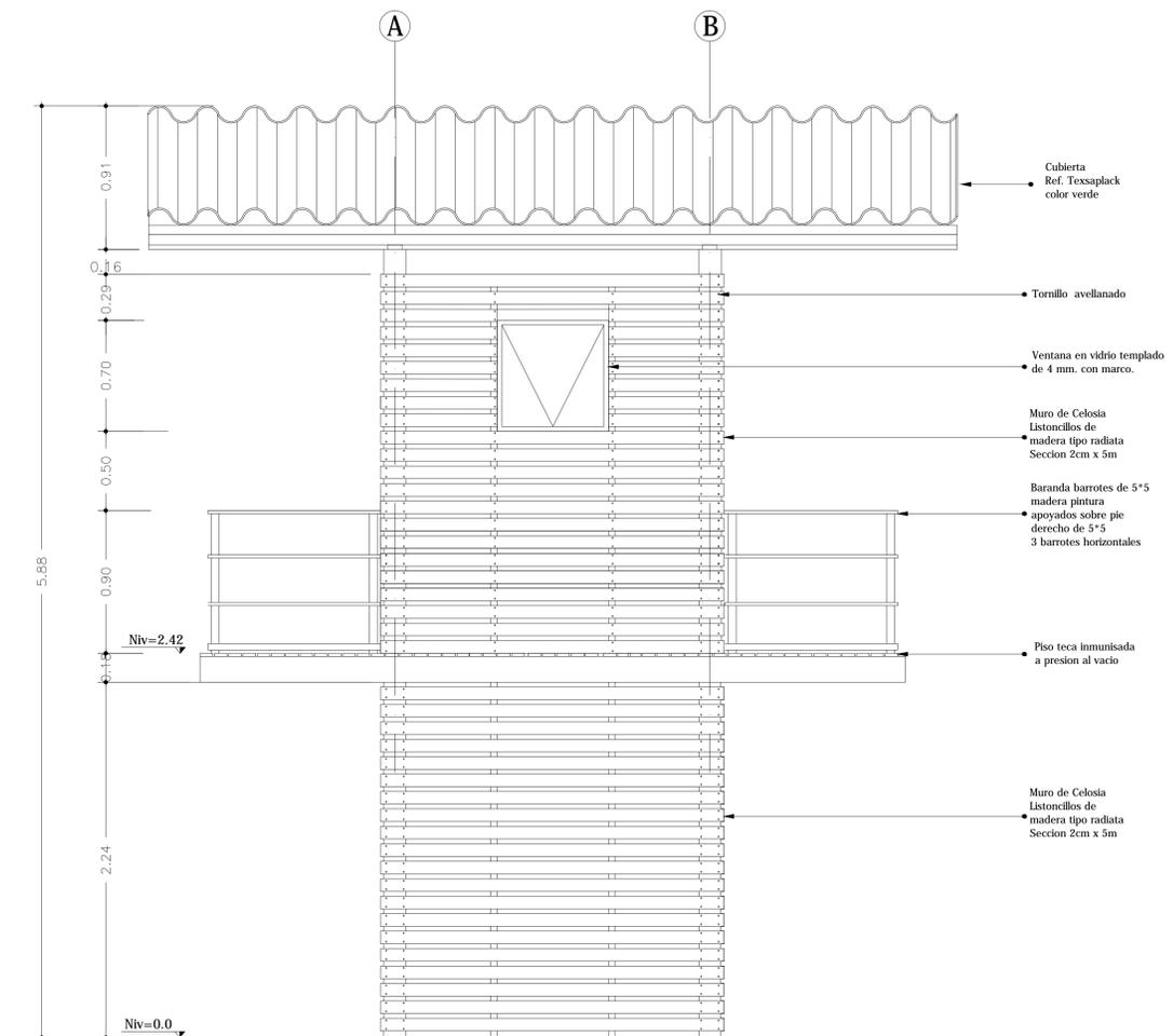
Nota: Inmunización con el sistema de presión y vacío sales CCA (Cobre, Cromo y Arsenico), retención de 4,00 km/m3
