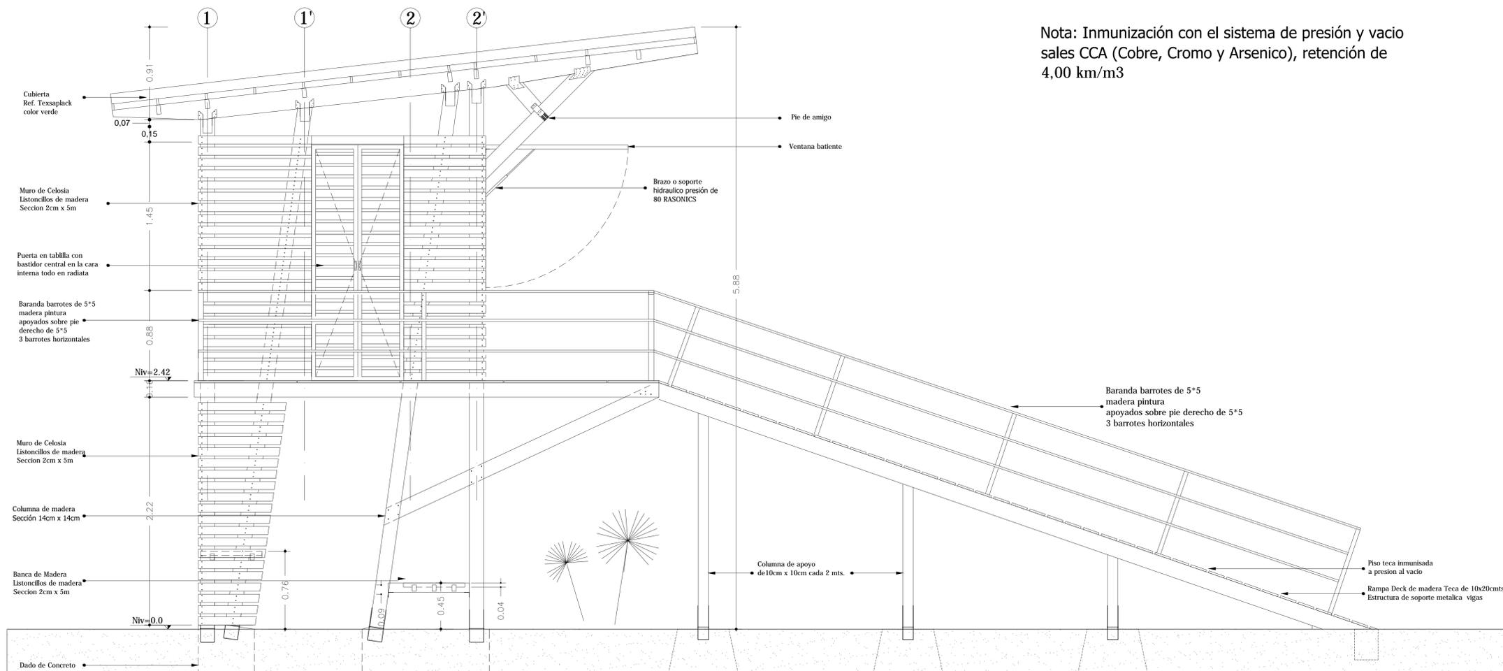
Nota: Inmunización con el sistema de presión y vacío sales CCA (Cobre, Cromo y Arsenico), retención de 4,00 km/m3
