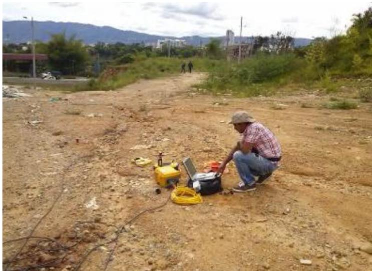
**Fotografía 6**– Sitio de realización de la línea de refracción sísmica
